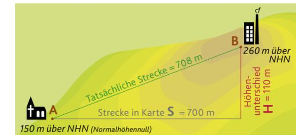
Der Höhenunterschied H zwischen A (150 m) und B (260 m) beträgt anhand der Höhenangaben aus der Karte 110 m. Die aus der Karte abgegriffene Strecke S beträgt 700 m.
